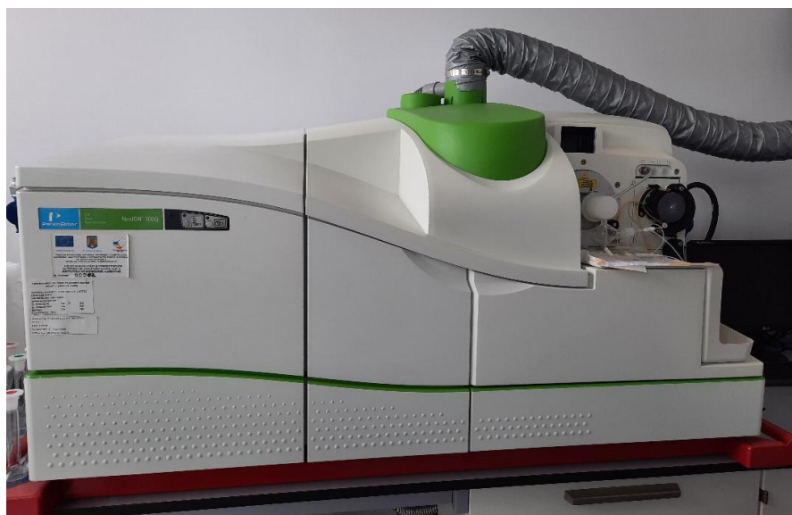
Figura 8.2. Spectrometru de masă cu plasmă cuplată inductiv (ICP-MS), model NexION300Q
