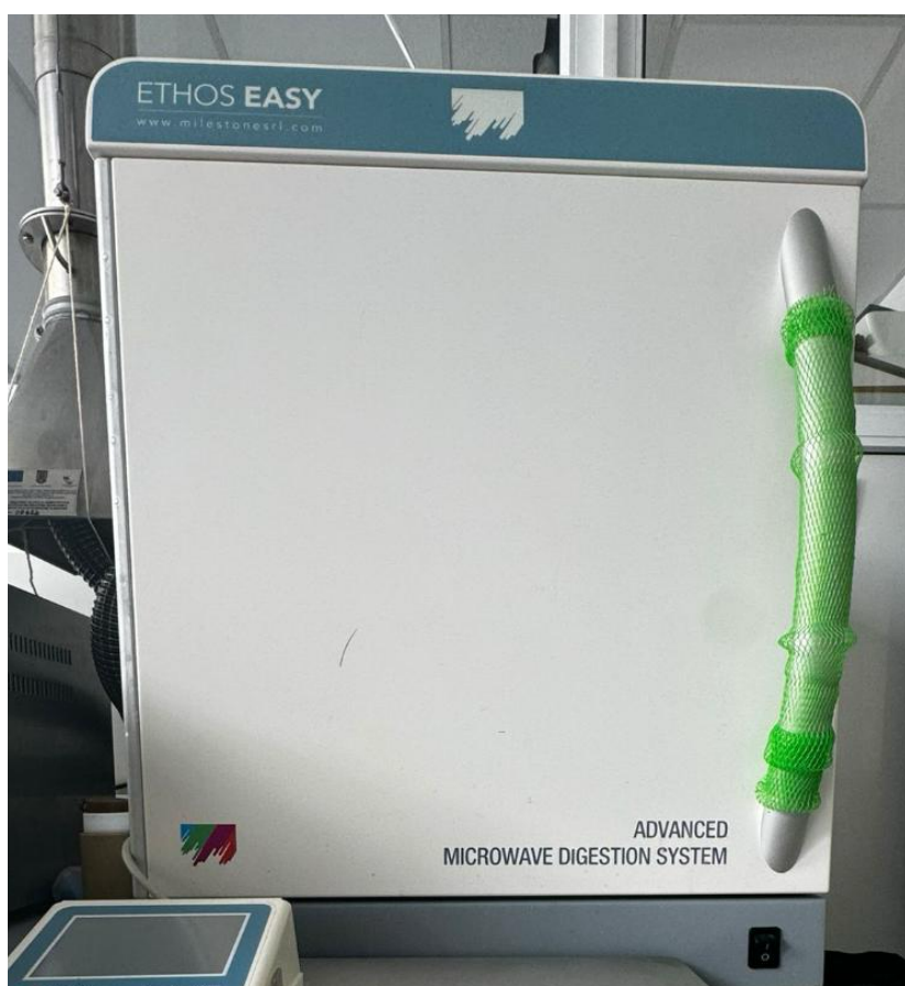
Figura 8.1. Sistem de digestie cu microunde, model Ethos Easy
