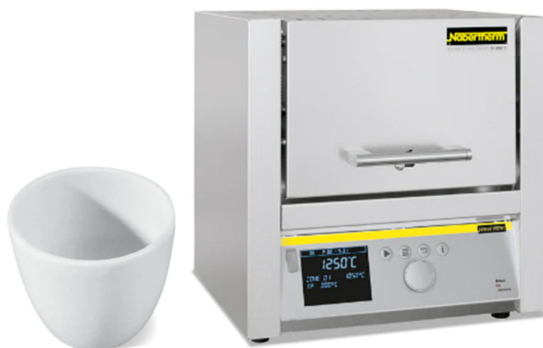
Figura 5.4. Echipamentele utilizate pentru determinarea conținutului de cenușă (creuzet și cuptor de calcinare)
