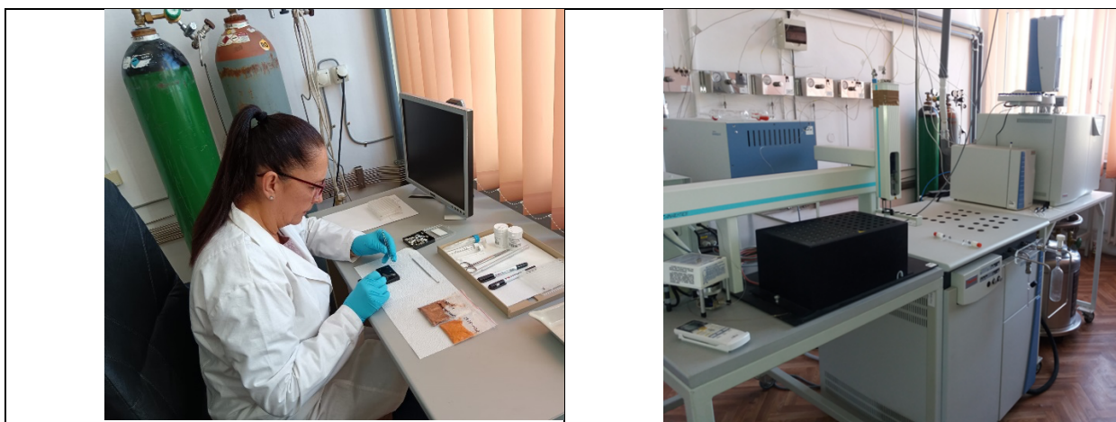
Figura 9.4. Pregătirea capsulelor cu probe și determinările cu spectrometrul de masă Dela V Advantage
