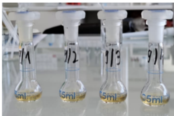
Figura 10.8. Cele patru probe de pielite de roșii (EtU, EtA, MeU, MeA) în prima etapă de a reacției colorimetrice (a), respectiv în etapa finală (b)
