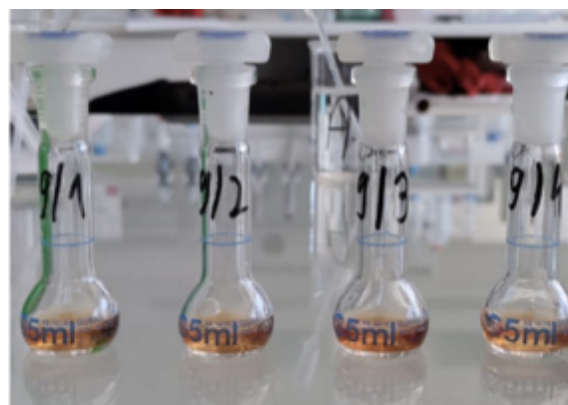
Figura 10.8. Cele patru probe de pielite de roșii (EtU, EtA, MeU, MeA) în prima etapă de a reacției colorimetrice (a), respectiv în etapa finală (b)
