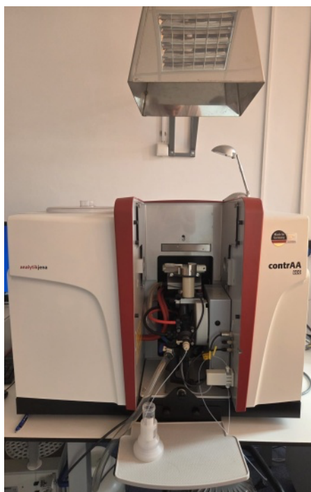
Figura 9.2. Spectrometrul ContraAA 800D de absorbție atomică în flacără utilizat pentru determinarea conținutului elemental.
