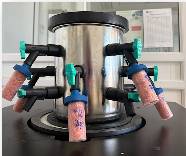
Figura 10.1. Pielitele de roșii supuse procesului de liofilizare (liofilizator IShin FD5512)
